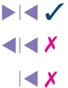
Insérez le bâtonnet-test dans l'appareil de manière à ce que les flèches violettes pointent l'une vers l'autre.
